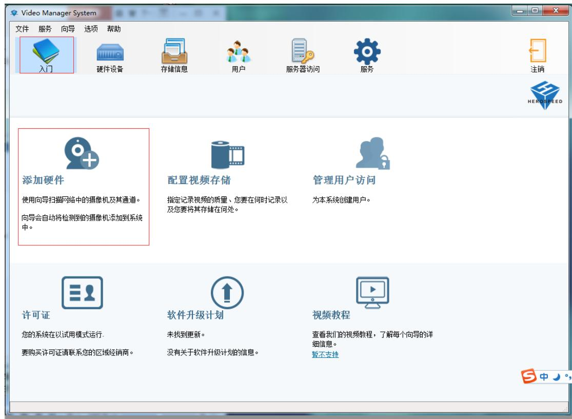
弹出添加加硬件对话框,扫描硬件是可以直接扫描局域网里面的硬件设备,也可以扫描指定网段的硬件设备;手动添加硬件就是直接添加知道地址或者序列号的硬件设备.
