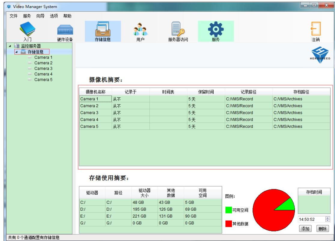
编辑通道的存储配置,双击右边的列表框进入记录和存储属性,可以只给某一个摄像机配置也可以使用模板给多个摄像机配置, (使用模板配置见 2.1.3.3) .
